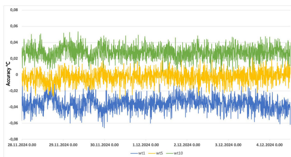
Kuva 15 b Anturien tarkkuus Faradayn häkissä. Yksittäisten sensorien kohina
