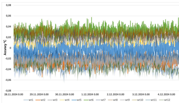
Kuva 15a Anturien tarkkuus Faradayn häkissä. Anturit on numeroitu juoksevalle numerolla
